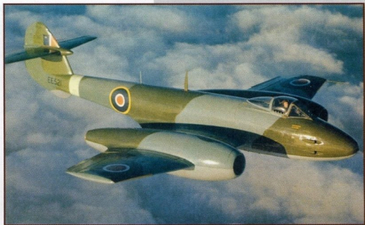
GLOSTER METEOR F.4 – STÍHAČKY TÉTO VERZE ZAČALY BÝT PERUTÍM RAF DODÁVÁNY AŽ V ROCE 1947. OD DŘÍVĚJŠÍ VERZE SE ODLIŠUJÍ JINÝMI GONDOLAMI MOTORŮ DERWENT 5.
