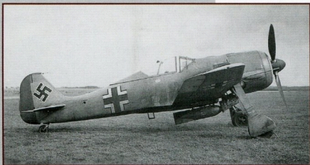
Fw 190 A-0/U3 ANEB PROTOTYP V8 STÍHAČÍHO BOMBARDÉRU Fw 190 A-3/U3. MODIFIKACE SPOČÍVALA V MONTÁŽI ZÁVĚSNÍKU NA BOMBU O HMOTNOSTI 250 KG.
