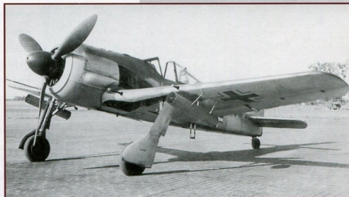
PŘEPADOVÁ STÍHAČKA Fw 190 A-4 S RAKETNICEMI PRO RAKETY WGr.21 RÁŽE 210 MM POUŽÍVANÉ K ÚTOKŮM PROTI SEVŘENÝM FORMACÍM SPOJENECKÝCH TĚŽKÝCH BOMBARDÉRŮ.
