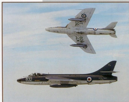
DVA HUNTERY GA.11 (č. XE688 a WT809) POUŽÍVANÉ U FRADU K NÁCVIKU OVLÁDÁNÍ ZBRANOVÝCH SYSTÉMŮ. TATO VERZE VZNIKLA KONVERZÍ HUNTERŮ F.4 SLOUŽÍCÍCH DŘÍVE U RAF.
