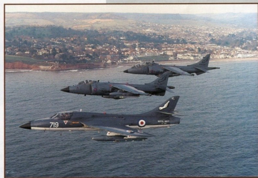
LETOUN V POPŘEDÍ JE HUNTER T.8M (č. XL580) z 899. NÁMOŘNÍ LETECKÉ PERUTĚ FLEET AIR ARM, ZA NÍM LETÍ DVA SEA HARRIERY STEJNÉ PERUTĚ. TŘI HUNTERY T.8 PŘESTAVĚNÉ NA STANDARD T.8M SLOUŽILY PILOTŮM NÁMOŘNÍHO LETECTVA K VÝUCE OBSLUHY RADARU BLUE FOX POUŽÍVANÉHO V LETADLECH SEA HARRIER.
