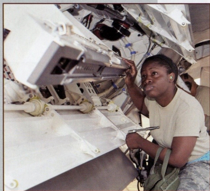
ZBROJÍRKA KONTROLUJE KOMORU PRO STŘELY VZDUCH-VZDUCH V TRUPU STÍHAČKY F-22 RAPTOR.
