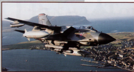
TORNADO GR.1B Z BRITSKÉ 617. PERUTÉ RAF DISLOKOVANÉ NA ZÁKLADNĚ LOSSIEMOUTH NESE POD TRUPEM PODVĚŠENY DVĚ ŘÍZENÉ PROTILODNÍ RAKETOVÉ STŘELY SEA EAGLE.
