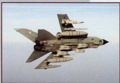
TORNADO GR.4 Z BRITSKÉ 31. PERUTÉ (No. 31 SQUADRON) RAF NESOUCÍ NA PODTRUPOVÝCH ZÁVĚSNÍCÍCH PROTITANKOVÉ ŘÍZENÉ STŘELY VZDUCH-ZEMĚ MBDA BRIMSTONE MÁ NA KŘÍDELNÍCH ZÁVĚSNÍCÍCH PROTIRADAROVÉ ŘÍZENÉ STŘELY ALARM A VÝMETNICE KLAMNÝCH CÍLŮ BOZ-107.
