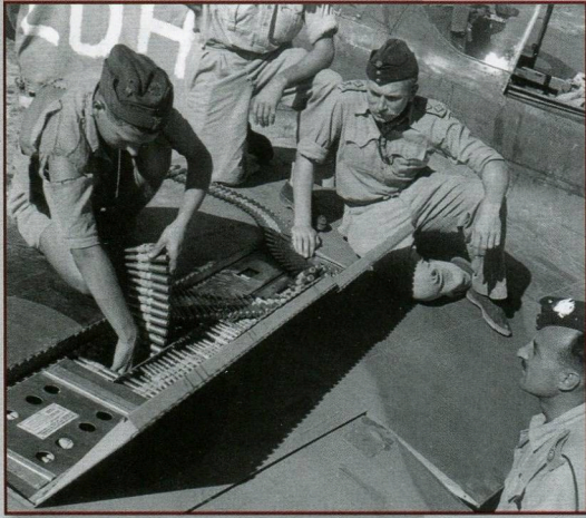
DOPLŇOVÁNÍ STŘELIVA RÁŽE 12,7 MM DO MUNIČNÍ SCHRÁNKY KŘÍDELNÍCH KULOMETŮ BROWNING STÍHAČKY KITTYHAWK Mk. III. ZBROJMISTROVU ČINNOST SLEDUJÍ DVA DŮSTOJNÍCI BRITSKÉ 8. ARMÁDY, KTEŘÍ BYLI NA STÁŽI U RAF V RÁMCÍ SNAHY O ZLEPŠENÍ SOUČINNOSTI LETECTVA A POZEMNÍCH SIL 8. ARMÁDY.
