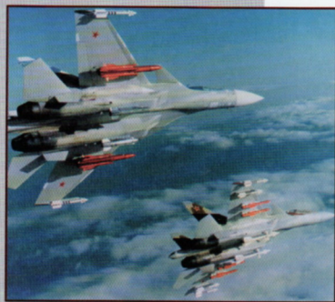
DVOJICE LETADEL SU-35 NAZÝVANÝCH „FLANKERY DRUHÉ GENERACE“. STROJE NA FOTOGRAFII NESOU ROZDÍLNÉ SESTAVY VÝZBROJE – BLÍŽŠÍ LETADLO JE VÝZBROJENO HLAVNĚ STŘELAMI VZDUCH-ZEMĚ, KDEŽTO VZDÁLENĚJŠÍ LETOUN JE VÝZBROJEN STŘELAMI VZDUCH-VZDUCH.
