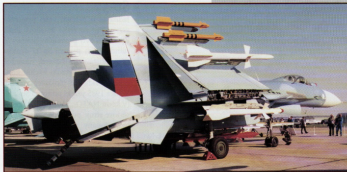
POD SLOŽENÝMI KŘÍDLY PALUBNÍ STÍHAČKY SU-33 JE VIDĚT ČÁST SESTAVY PODVĚŠENÉ VÝZBROJE.
