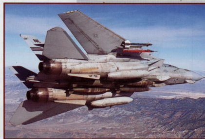
NA STÍHAČCE F-14A Z NÁMOŘNÍ STÍHAČI PERUTĚ VF-51 „SCREAMING EAGLES“ VYFOTOGRAFOVANÉ BĚHEM OTÁČENÍ JE DOBRĚ VIDĚT PODVĚŠENOU VÝZBROJ – ČTYŘI BOMBY Mk. 84 O JEDNOTKOVÉ HMOTNOSTI 907 KG A ŘÍZENÉ STŘELY VZDUCH-VZDUCH AIM-9 SIDEWINDER. LETADLO NESE TAKÉ Dvě PODVĚŠENÉ PALIVOVÉ NÁDRŽI
