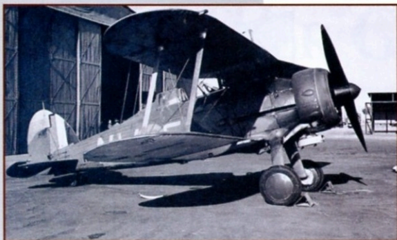
GLOSTER GLADIATOR Mk. I z 33. PERUTĚ (No. 33 SQUADRON RAF) BOJUJÍCÍ V LÉTĚ 1940 S ITALSKÝM LETECTVEM (REGIA AERONAUTICA) NA BLÍZKÉM VÝCHODĚ. STÍHAČKA MÁ NA VSTUPU VZDUCHU DO MOTORU INSTALOVANÝ POUŠTNÍ FILTR VOKES.
