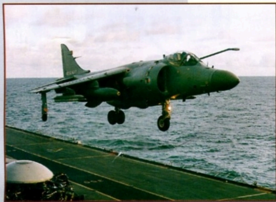
SEA HARRIER FA.2 PŘISTÁVAJÍCÍ NA PALUBĚ BRITSKÉ LETADLOVÉ LODĚ JE VYZBROJEN GONDOLAMI S KANONY A CVIČNÝMI VERZEMI RAKETOVÝCH STŘEL VZDUCH-VZDUCH SIDEWINDER. POD KŘÍDLY LETADLA JSOU VIDĚT PŘÍDAVNÉ PALIVOVÉ NÁDRŽE.
