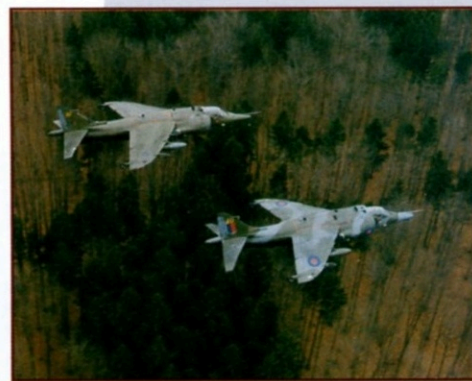
DVOJICE LETADEL HARRIER GR.3 ZE 3. PERUTĚ (No. 3 SQUADRON RAF). LETADLO VLEVO NESE EXPERIMENTÁLNÍ KAMUFLÁŽ, KTERÁ BYLA POZDĚJI PŘIJATA JAKO ZÁVAZNÁ PRO VŠECHNY STROJE VERZE GR.5.
