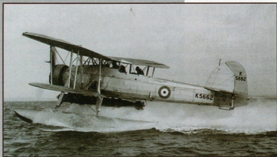
START JEDNOHO ZE TŘÍ PŘEDVÝROBNÍCH EXEMPLÁŘŮ STROJE FAIREY SWORDFISH (ČÍSLO K5662) S PODVĚŠENÝM TORPÉDEM. SNÍMEK BYL POŘÍZEN BĚHEM LETOVÝCH ZKOUŠEK S PLOVÁKY.
