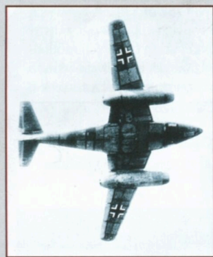
MESSERSCHMITT Me 262 – PŘI POHLEDU ZESPODU JE DOBRĚ VIDĚT CHARAKTERISTICKÝ TVAR TRUPU A KŘÍDEL SE DVĚMA MOTOROVÝMI GONDOLAMI, V NICHŽ BYLY UMÍSTĚNY PROUDOVÉ MOTORY.
