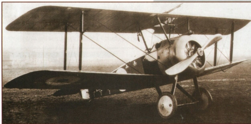
SOPWITH 2F.1 CAMEL – LODNÍ VERZE SE OD POZEMNÍ STÍHAČKY NA PRVNÍ POHLED ODLIŠOVALA MONTÁŽÍ JEDNOHO KULOMETU LEWIS NAD HORNÍM KRÍDLEM.
