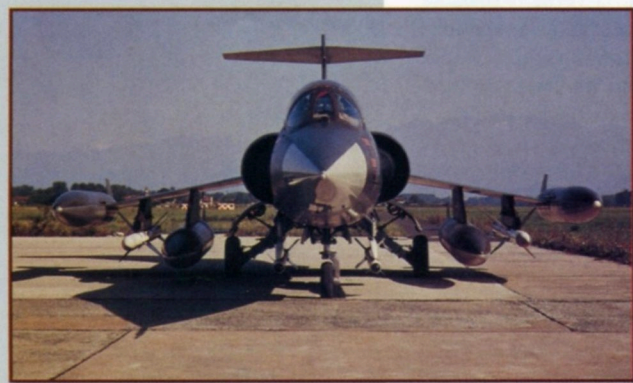
F-104S STARFIGHTER ITALSKÉHO LETECTVA S KOMPLETNÍ SESTAVOU NESENÉ VÝZBROJE. DÍKY MODIFIKACI AVIONIKY MOHLA ITALSKÁ LETADLA NĚST RAKETY VZDUCH-VZDUCH STŘEDNÍHO DOLETU – JAK AMERICKÉ AIM-7 SPARROW, TAK ITALSKÉ ASPIDE.
