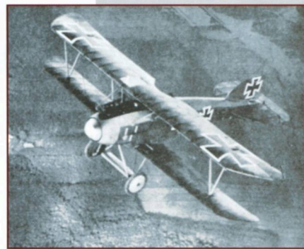
LETČÍ ALBATROS D.III Z MARINE FELD JASTA II MÁ KŘÍDLA POTAŽENÁ PLÁTNEM S KAMUFLÁŽNÍM VZOREM BUNTFARBENAUFDRUCK.
