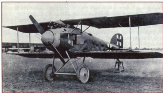
ALBATROS D.II BYL V PODSTATĚ VÝVOJOVOU VERZÍ TYPU D.I. HORNÍ KŘÍDLO BYLO UMÍSTĚNO BLÍŽE K TRUPU PRO ZLEPŠENÍ VÝHLEDU PILOTA PŘED A NAD LETADLO.
