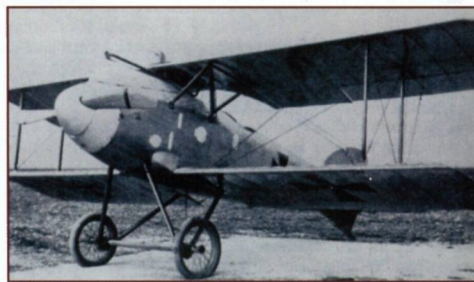
ALBATROS D.II VYRÁBĚNÝ V RAKOUSKU MÁ CHLADIČ MOTORU AUSTRO-DAIMLER UMÍSTĚN JINAK NEŽ LETADLA NĚMECKÉ VÝROBY.
