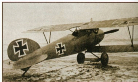
ALBATROS D.VA – HLAVNÍ VNĚJŠÍ ROZDÍL MEZI VERZEMI D.V A D.VA BYL ODLIŠNÝ ZPŮSOB TAŽENÍ OVLÁDACÍCH LANEK VZTLAKOVÝCH KŘÍDÉLEK.
