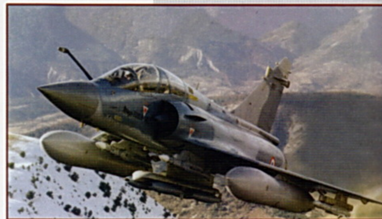
LETADLO MIRAGE 2000-5 Mk 2 JE VÝRAZNĚ MODERNIZOVANOU VERZÍ S RADAREM RDY-2 ZNAČNĚ ZVYŠUJÍCÍM BOJOVÉ SCHOPNOSTI STROJE V POMĚRU K PŘEDCHOZÍM VERZÍM. NA VNĚJŠÍCH ZÁVĚSNÍCÍCH JSOU VIDĚT INFRAČERVENĚ NAVÁDĚNÉ RAKETY VZDUCH-VZDUCH MICA IR, DVĚ PALIVOVÉ NÁDRŽE, RADAREM NAVÁDĚNÉ RAKETY VZDUCH-VZDUCH MICA ER A NA KONZOLÁCH POD TRUPEM ČTYŘI BOMBY, KAŽDÁ O HMOTNOSTI 250 KG.
