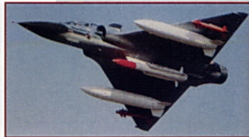
LETOVÝ SNÍMEK PRVNÍHO PROTOTYPU MIRAGE 2000N VYZBROJENÉHO STŘELOU S PLOCHOU DRÁHOU LETU STŘEDNÍHO DOLETU ASMP S JADERNOU HLAVICÍ, DVĚMA RAKETAMI VZDUCH-VZDUCH R550 MAGIC A S ATYPICKÝMI PALIVOVÝMI NÁDRŽEMI POD KŘÍDLY.
