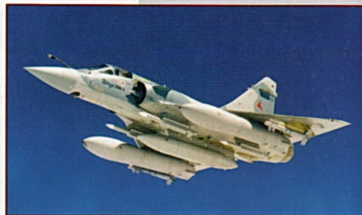
MODERNIZOVANÁ VARIANTA LETADLA DASSAULT MIRAGE 2000B/C OZNAČENÁ MIRAGE 2000-5. NA FOTOGRAFII JE JEDEN Z PROTYPŮ MIRAGE 2000-5F PŘESTAVĚNÝ ZE SÉRIOVÉHO EXEMPLÁŘE VERZE C. TÍMTO ZPŮSOBEM BYLO MODERNIZOVÁNO CELKEM 37 FRANCOUZSKÝCH STROJŮ MIRAGE 2000C.
