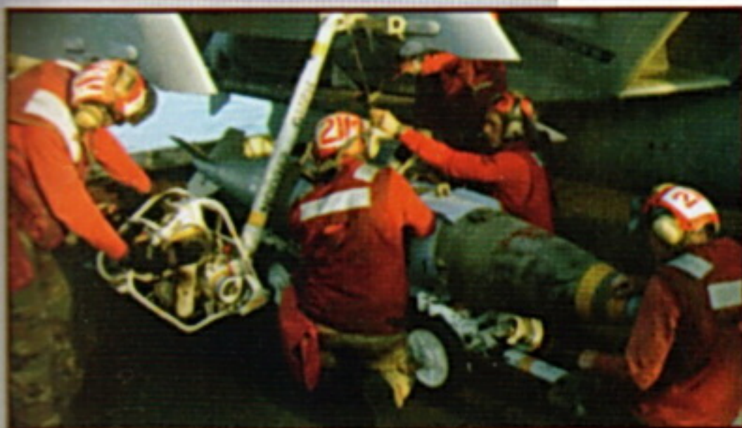
PALUBNÍ OBSLUHA PODVĚŠUJE POD LETADLO NAVÁDĚNOU BOMBU GBU-31 JDAM (BOMBA BLU-109 O HMOTNOSTI 907 KG S INSTALOVANÝM NAVÁDĚCÍM MODULEM). VZADU JE VIDĚT JÍŽ PODVĚŠENOU RAKETU VZDUCH-VZDUCH AIM-120.
