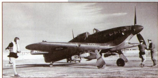
POZEMNÍ PERSONÁL PŘIPRAVUJE KE STARTU HAWKER HURRICANE MK IIB TROP. POD KŘÍDLY JSOU VIDĚT PODVĚŠENÉ BOMBY O HMOTNOSTI 113 KG A DOBRĚ VIDITELNÁ JSOU ROVNĚŽ ÚSTÍ KULOMETNÝCH HLAVNÍ V KŘÍDLECH. PILOT PŘÍBÍHÁJÍCÍ K LETADLU MÁ NA SOBĚ ZÁCHRANNOU VESTU „MÁE WEST“. FOTOGRAFIE BYLA POŘÍZENÁ NA MALTĚ.
