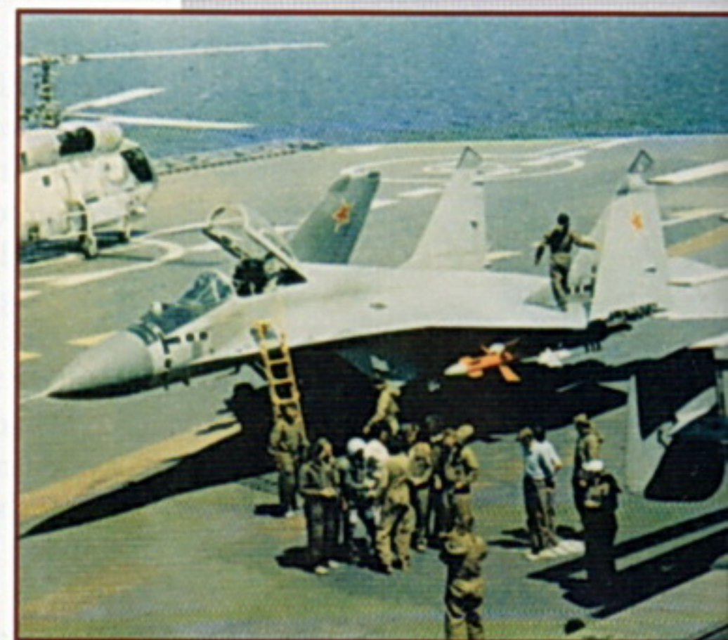
FOTOGRAFIE POŘÍZENÁ BĚHEM TESTŮ PRVNÍHO EXEMPLÁŘE NÁMOŘNÍ VERZE MiG-29K FULCRUM D URČENÉ PRO LETADLOVÉ LODĚ. STROJ, KTERÝ PRÁVĚ PŘISTÁL, NESE POD KŘÍDLY RAKETY R-73 A R-77.
