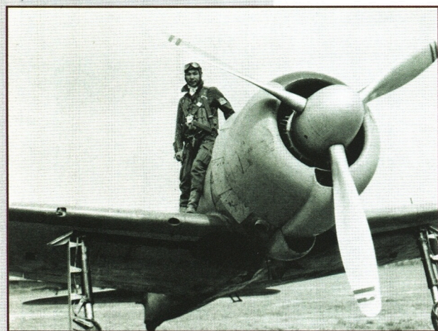
A6M2 MODEL 11; PODLE UMÍSTĚNÍ VÝFUKOVÉHO POTRUBÍ LZE USODUIT, ŽE LETOUN NA SNÍMKU POCHÁZÍ Z RANÉ VÝROBNÍ SÉRIE – U POZDĚJŠÍCH STROJŮ SE VÝFUK NACHÁZEL O NĚCO VÝŠE.
