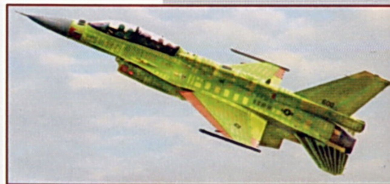
SNÍMEK PRVNÍHO LETOUNU F-16D BLOCK 52 URČENÉHO PRO ŘECKÉ VZDUŠNÉ SÍLY. PO DOBU LETOVÝCH ZKOUŠEK LÉTAL STROJ BEZ KAMUFLÁŽE, POUZE SE ZÁKLADNÍM NÁTĚREM.
