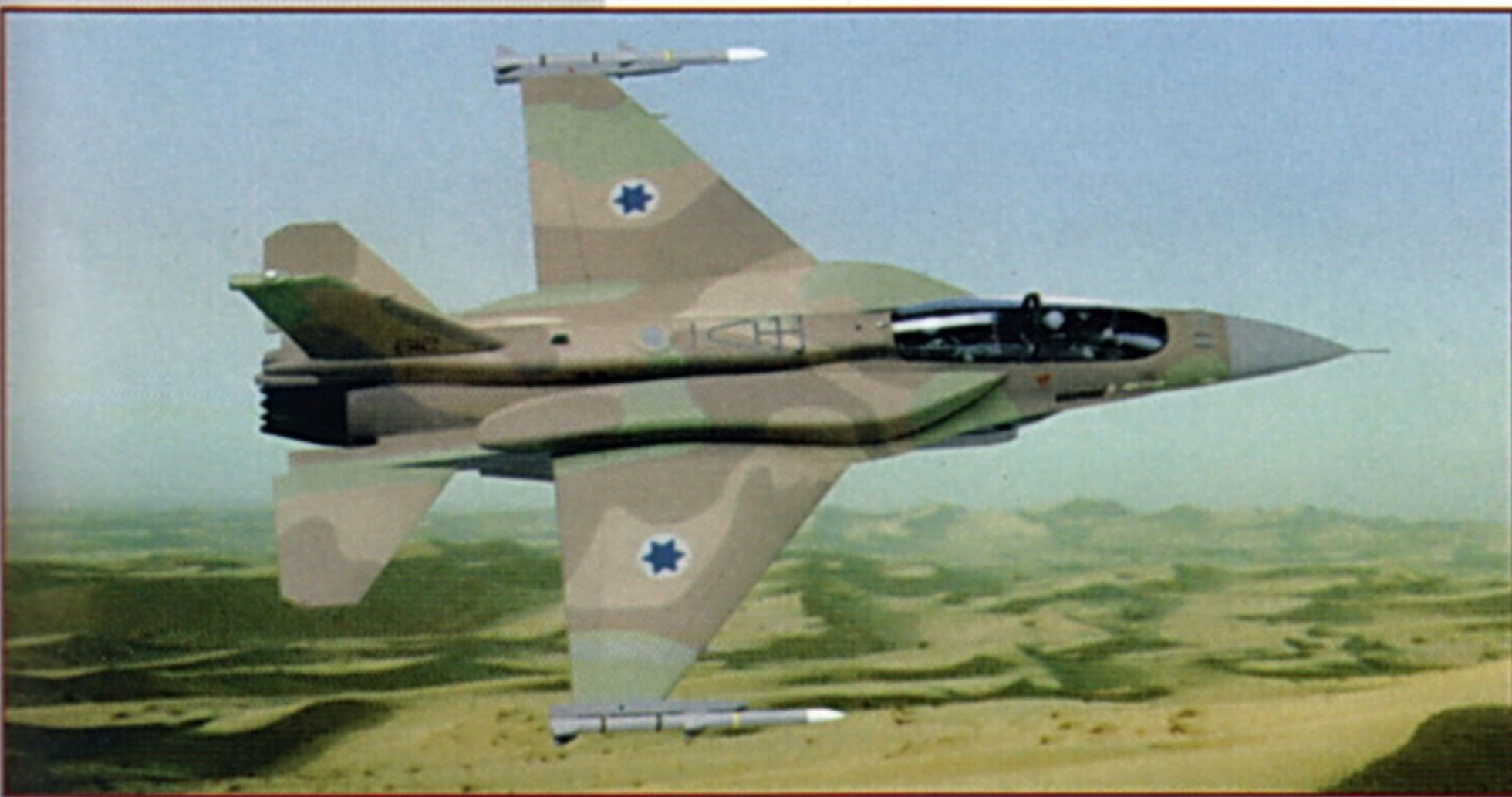
IZRAELSKÝ F-16D BLOCK 52+; NA LETOVÉM ZÁBĚRU JSOU VÝBORNĚ PATRNÉ DODATEČNÉ PALIVOVÉ NÁDRŽE CFT (CONFORMAL FUEL TANKS) UMÍSTĚNÉ NA VRCHNÍ STRANĚ TRUPU.
