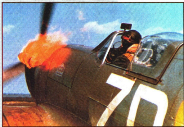
KRÁSNA FOTOGRAFIE ZACHYCUJÍCÍ OKAMŽIK „NASKOČENÍ“ MOTORU BĚHEM STARTOVÁNÍ. Z VÝSTUPNÍCH TRYSEK ŠLEHÁ OHEŇ ZE ZAPÁLENÉ BOHATÉ POHONNÉ SMĚSI.
