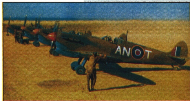
LETOUNY SPITFIRE Mk VB(TROP) 417. PERUTĚ, KTERÁ SE V ÚNORU 1942 PŘESUNULA Z VELKÉ BRITÁNIE DO SEVERNÍ AFRIKY. PO CELOU DOBU BOJŮ V TĚTO OBLASTI LÉTALI PILOTI TĚTO JEDNOTKY NA STROJÍCH VERZE Mk V. LETOUNY NA SNÍMKU JSOU VYBAVENY TROPICKÝM FILTREM TYPU VOKES.
