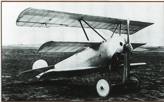
D.VI BYL PRVNÍ PROTOTYP TROJPLOŠNÉ STÍHAČKY ANTONA FOKKERA. LETADLO MĚLO SAMONOSNÁ KŘÍDLA, KTERÁ NEVYŽADOVALA VZPĚRY A VYZTUŽENÍ DRÁTEM. CELÝ STROJ BYL NATŘEN STŘÍBROŠEDOU BARVOU A NEBYL VYZBROJEN.
